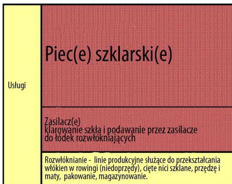
Rysunek 4. Granice systemu; procesy objęte granicami systemu są zaznaczone na czerwono (ciemne pola) (“Rule book” dla produktów z włókna szklanego ciągłego (CFGF), 2010)
